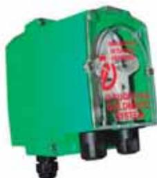
Material: PP. Verde. Caudal máximo: 5 l/h - Presión máxima: 0,1 bar - Material tubo peristáltico : santopreno - Tubo de conexión: 4 x 6 mm - Alimentación: 230 Vac - 50/60 Hz - Protección: IP 65 - Material cuerpo bomba : PP color verde -
