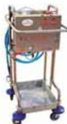
Dimensiones: 600 x 1100 x 700 mm - Equipo móvil - Aire comprimido - Boquilla: específica por producto - Conexión a la red de agua - Presión agua: 2-5 bar - Dosifica 2 productos -
