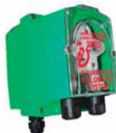
Material: PP. Verde. Caudal máximo: 1 l/h - Presión máxima: 4 bar - Material tubo peristáltico : silicona - Tubo de conexión: 4 x 6 mm - Alimentación: 230 Vac - 50/60 Hz - Protección: IP 65 - Material cuerpo bomba : PP color verde -
